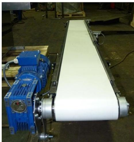
Являются одним из самых распространенных видов транспортирующих устройств в промышленности и предназначены для перемещения разнообразных грузов: сыпучих, кусковых, штучных. Наше предприятие изготавливает ленточные конвейеры различной длины и различных конструктивных исполнений - по схеме трассы: горизонтальные, наклонные, составные.
