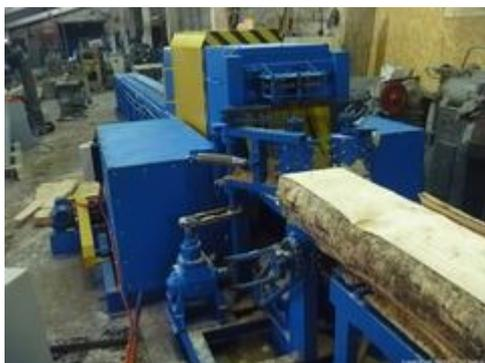
1. Рама станка выполнена с существенным запасом прочности, вибрации и любые деформации исключены полностью.
