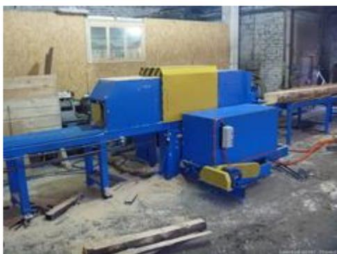
"ВЕПРЬ 700М" относится к станкам проходного типа, т. е. при обработке движется заготовка, а сам обрабатывающий узел неподвижен. Бревно подается в пильный узел с помощью цепной подачи. В базовой комплектации станок оснащается системой плавной регулировки скорости подачи с пульта оператора, которая
