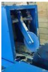
Все станки в базовой комплектации оснащаются системой стабилизации бревна при пилении.
