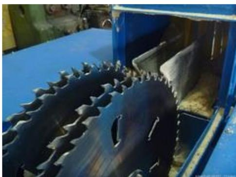
Максимальная скорость подачи сырья (скорость пиления) на практике ограничивается лишь мощностью двигателя привода пил, т. е. энергетическими ресурсами предприятия, эксплуатирующего станок. Пилы могут выдержать скорости подачи далеко выходящие за рамки разумных и экономически целесообразных значений.
