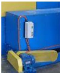
Многопильный брусовальный станок в базовой комплектации оснащается быстрой электромеханической регулировкой расстояния между центральными пилами. Такая конструкция станка позволяет менять размер центрального лафета одним нажатием кнопки. По желанию заказчика станок может быть оснащен электронной системой задания расстояния между
