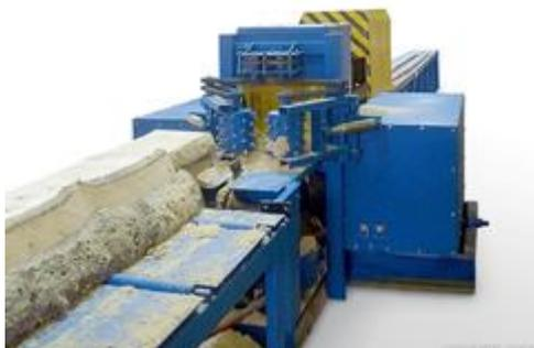
Дисковый брусующий (брусовальный) станок «ВЕПРЬ 700М» предназначен для распиловки в поточном режиме круглого леса на лафет и необрезную доску. Максимальный диаметр распиливаемой древесины - 250-320 мм, зависит от диаметра установленных пил.
