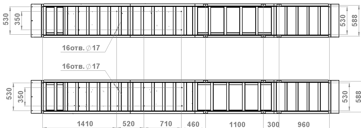
Рис. 3 Схема отверстий под анкерные болты (вид на платформу снизу)
